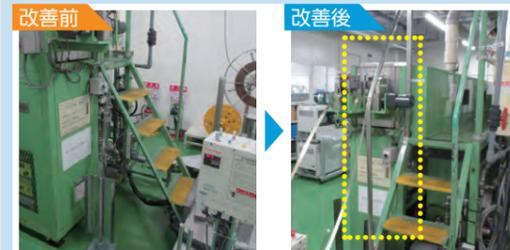
設備の階段の片方だけに手すりがあり、片手で昇降して、転倒、転落の危険があったため、両側に手すりを設置した。
