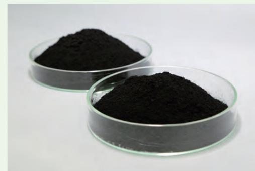
燃料電池用電極触媒
